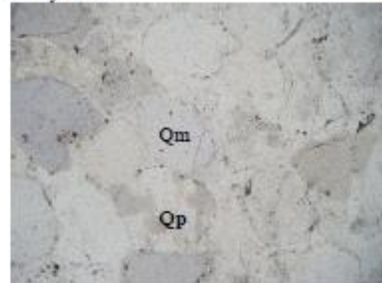
2-Qm Eski tane sınırı(hayalet sınırı), kuvarts çimento
